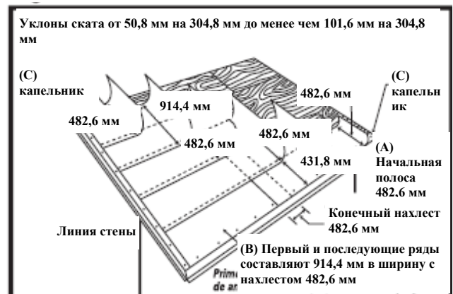
Рис. 3А Низкий уклон ската для подстилающего слоя
