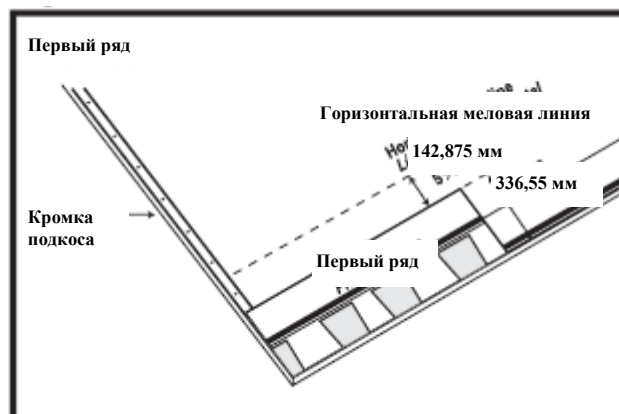
Рис. 5В Нанесение кровельных плиток
